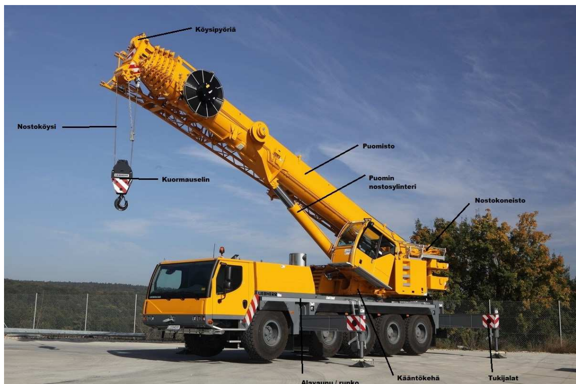
Kuva 7. Liebherr LTM 1095-5.1 -ajoneuvonosturi työskentelyasennossa (Liebherr 2019)
