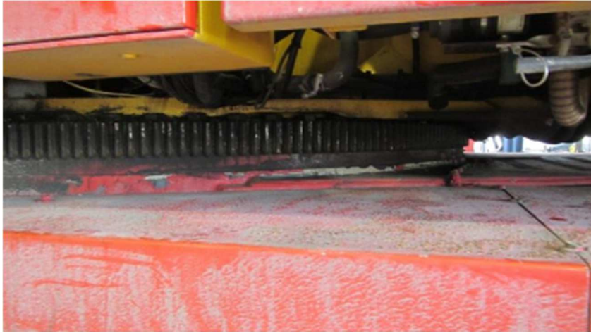
Kuva 10. Ajoneuvonosturin kääntökehän hammaspyörä
