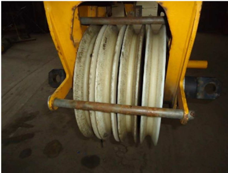
Kuva 9. Ajoneuvonosturin puominpään köysipyöriä
