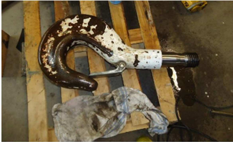
Kuva 12. Ajoneuvonosturin koukkutae purettuna tarkastusta varten
