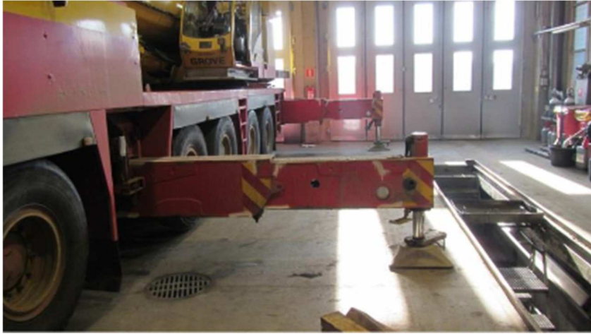
Kuva 11. Ajoneuvonosturin vasemmanpuoleiset tukijalat levitettynä
