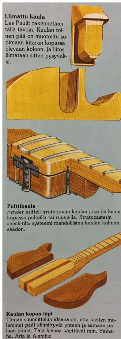
Kuva 19. Erilaisten kaulaliitosten tyypit [2, s. 51].
