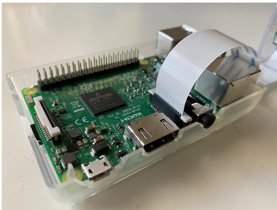
Kuva 4. 1. SDHC-muistikorttipaikka (pohjassa), 2. Micro-usb portti, 3. HDMI-portti, 4. Camera-portti, 5. Ethernet-portti, 6. USB-portit
