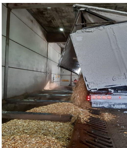
Kuva 22 Sivukippipurku suoraan monttuun (Teemu Rissanen, 10.4.2019)
