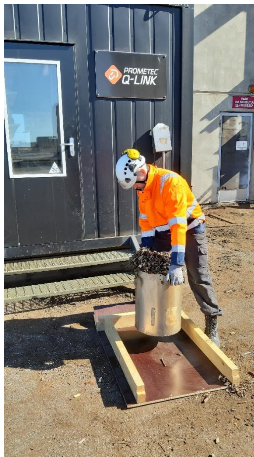
Kuva 12 50 litran säiliön tiputus 15 cm korkeudelta (Teemu Rissanen, 29.03.2019)
