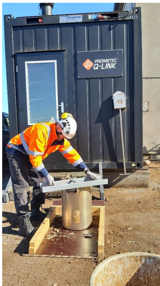
Kuva 12 50 litran säiliön tasoitus (Teemu Rissanen, 29.03.2019)
