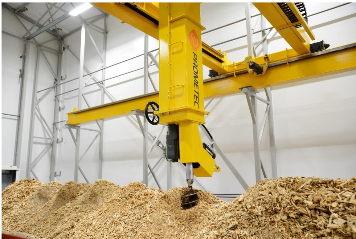
Kuva 19 Q-robot ottamassa näytettä kokopuu- ja rankahakkeesta (Aleksi Jussila, 21.4.2019)
