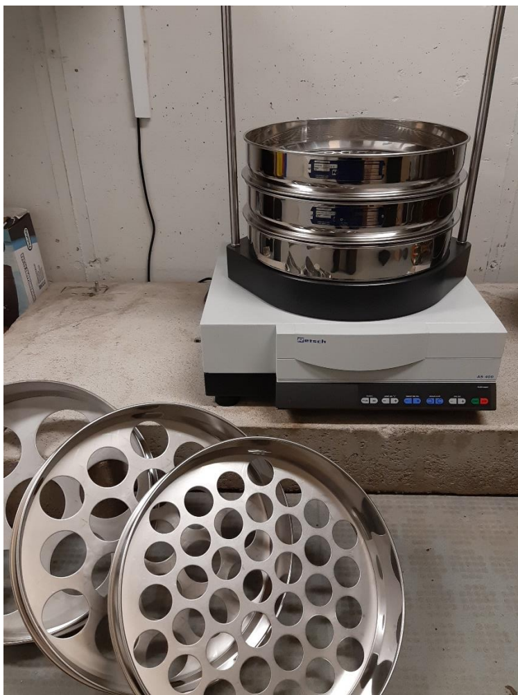
Kuva 26 Seulakone Retsch AS 400 control (Teemu Rissanen, 15.5.2019)
