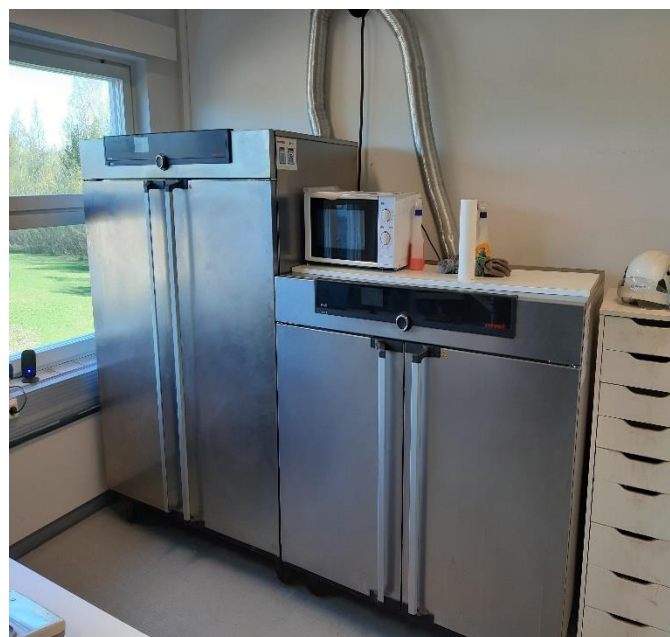
Kuva 25 Memmert UF750 lämpökaappi (Teemu Rissanen, 15.5.2019)
