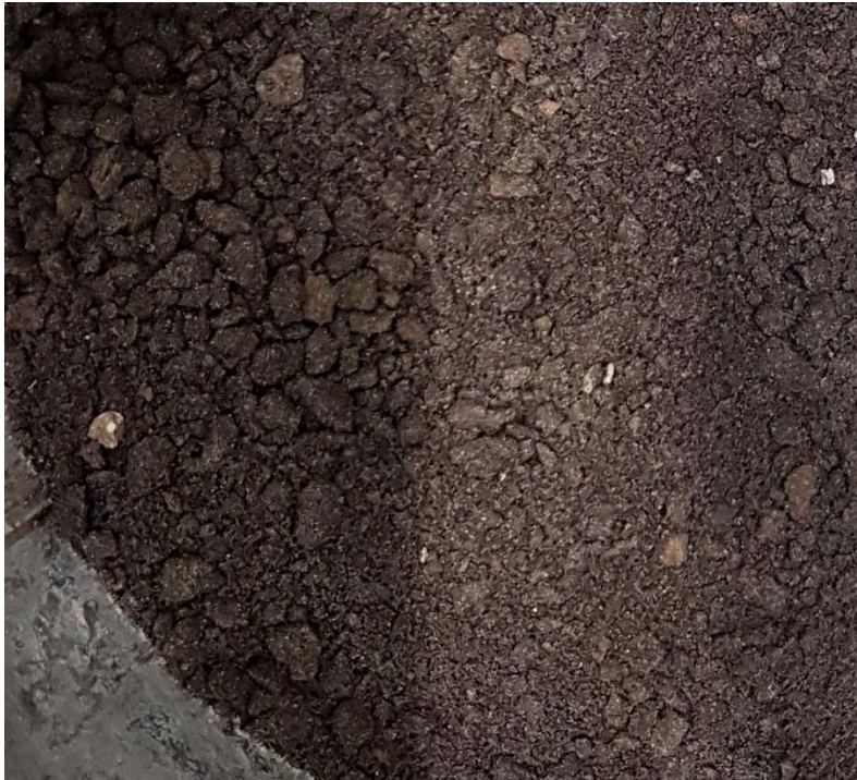
Kuva 18. Näyte valusenkkoihin asennettavasta tamppimassasta.
