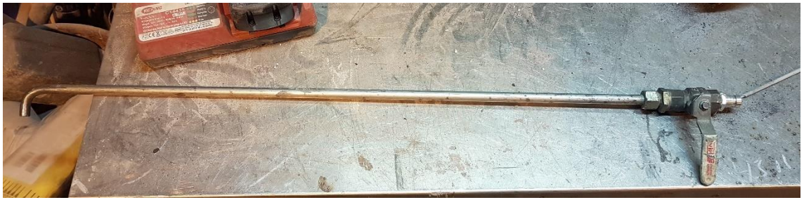
Kuva 19. Tutkimuksen aikana kehitetty työkalu kehystiilen puhdistamiseen paineilmalla valusenkan sisäpuolelta.
