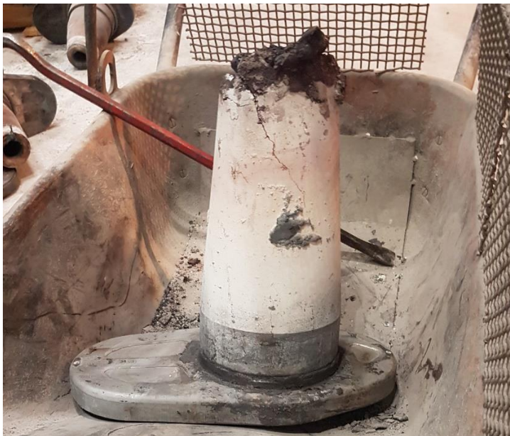
Kuva 14. Ensimmäinen uudenmallinen suutiili 7 valukerran jälkeen.
