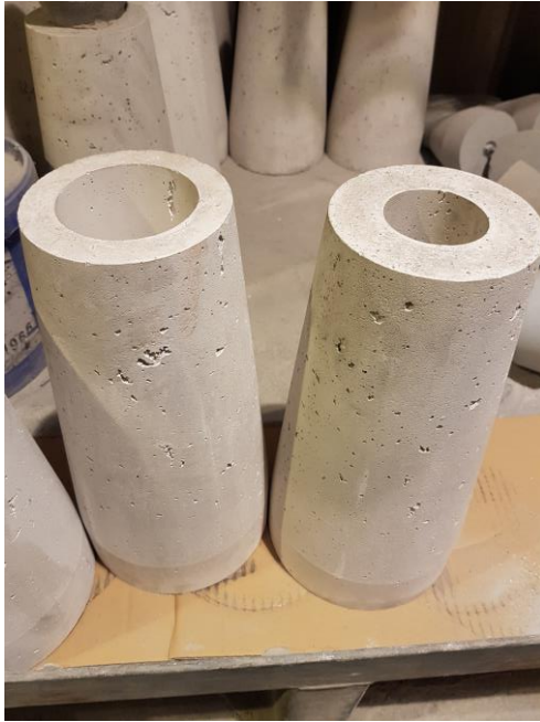
Kuva 12. Kuvassa vasemmalla uudenlainen testattava sekä oikealla käytössä oleva suutiili.
