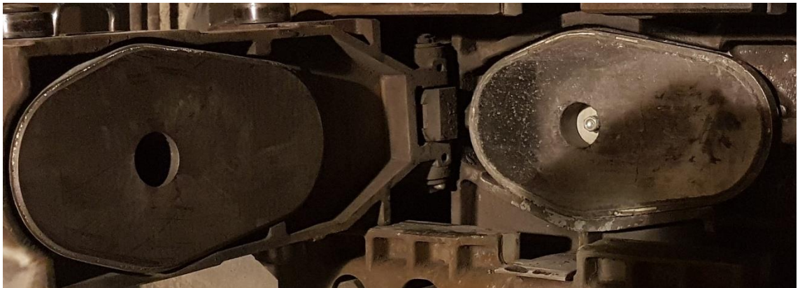
Kuva 8. Liukusuljinmekanismi avattuna. Alalevy ja ylälevyn näköiskappale paikalleen asennettuna.
