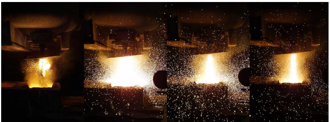
Kuva 4. Valusenkan vapaa aukeaminen liukusuljinmekanismia käyttäen (Purmetall 2019)
