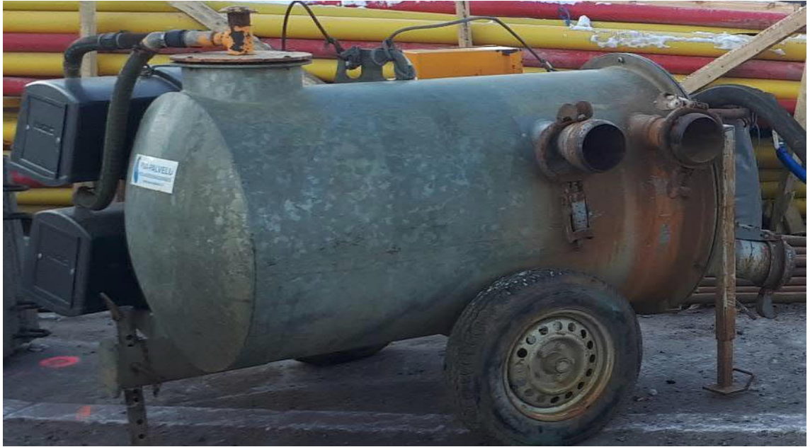
Kuva 8. Kuvassa on tyhjiömenetelmässä käytetty pohjaveden alennuspumppu [35.].
