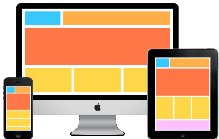
Kuva 2. Esimerkki siitä, miten sisältö voitaisiin näyttää eri tavoilla erikokoisilla näyttöillä responsiivisuutta käyttämällä (Caldwell 2013).
