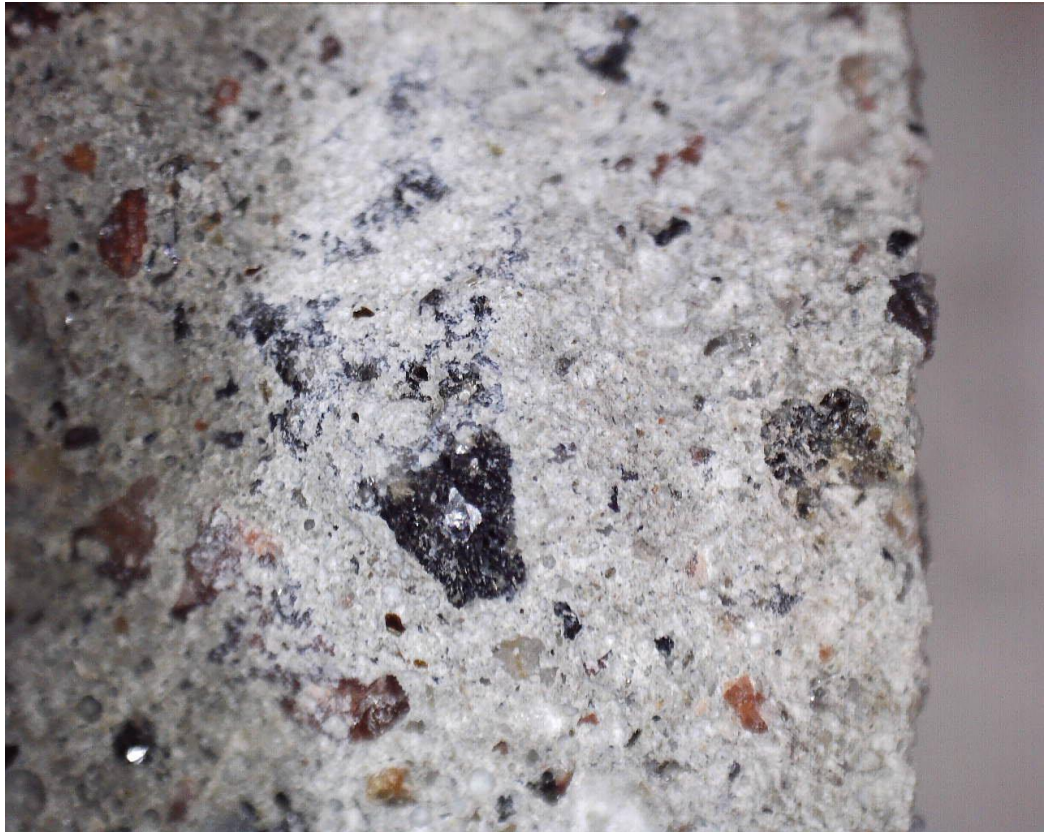
Kuva 25. Impregnoitu alue näkyy kuvassa vaaleampana
