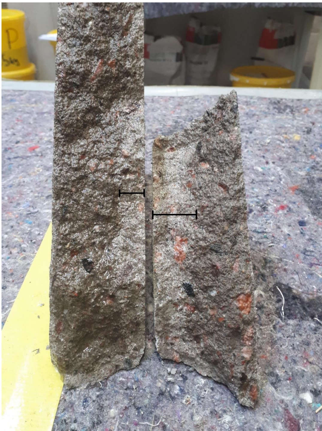
Kuva 14. Impregnointiaineen tunkeutuminen betoniin (impregnointiainerintama)
