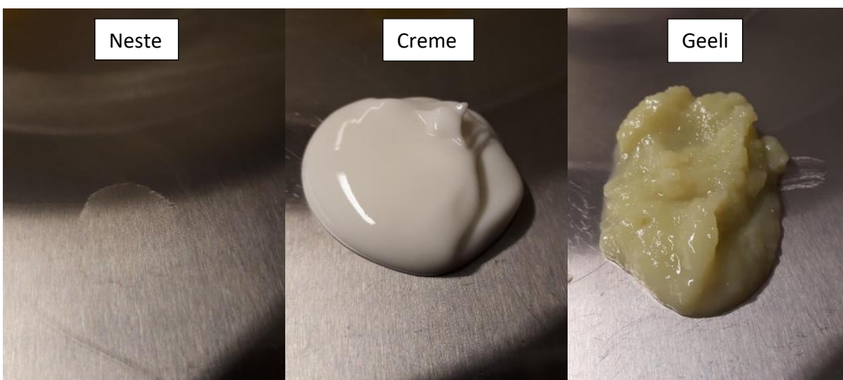
Kuva 15. Vettähylkivien impregnointiaineiden eri olomuodot
