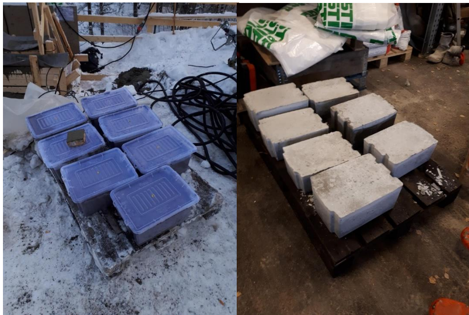
Kuva 16. Tunkeutumissyvyydestiä varten valetut betonipalat
