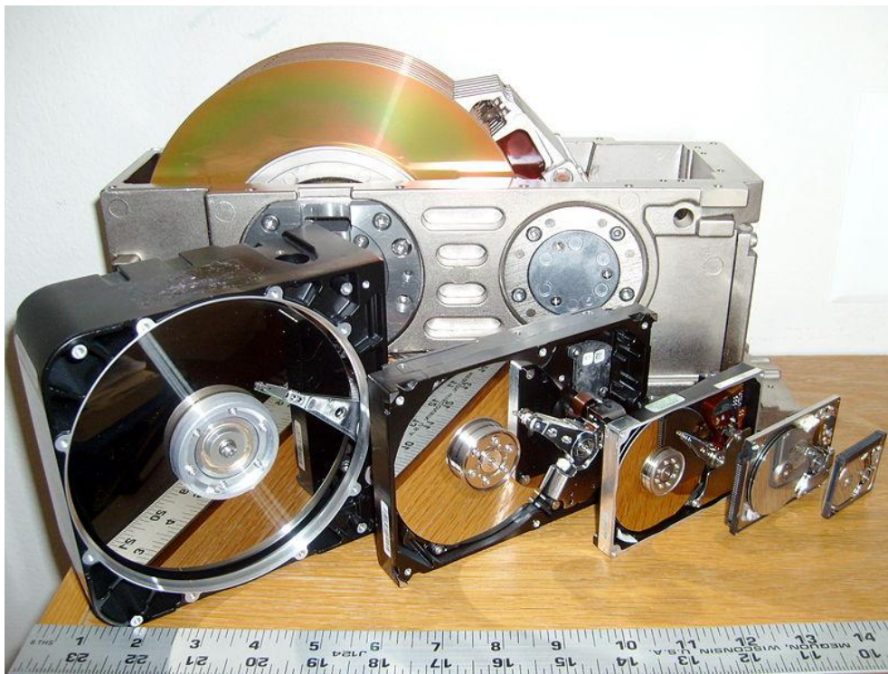
Kuva 5. Kiintolevyjen eri kokoformaatit. [16.]
