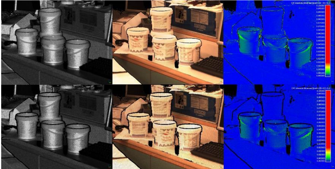
Kuva 4. Purkkien pinta on kääntynyt useita senttimetrejä (vasemmanpuoleisin purkki on kiertynyt 10 cm) referenssi- ja vertailtavan mittauksen välillä, mikä on selvästi nähtävissä RGB-väritetyssä pistepilvessä pinnan kuviosta ja todettavissa intensiteetin skalaarikenttä näkymässä purkkien kahvan liikkeestä. Kuitenkaan tätä liikettä ei pystytä toteamaan kummastakaan pistepilvestä toisen suhteen tehdystä heat-map-skalaarikentästä, sillä liike ei muuttanut purkin muotoa (lukuun ottamatta kahvan sijaintia). Heat-map-näkymässä kirkas vihreä väri osoittaa 1 cm:n eroa pilvien välillä.
