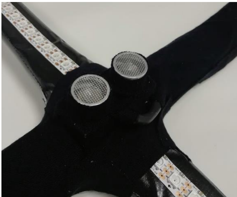
Kuvio 16 Ultraäänianturi kiinnitettyä mittalaitteeseen
