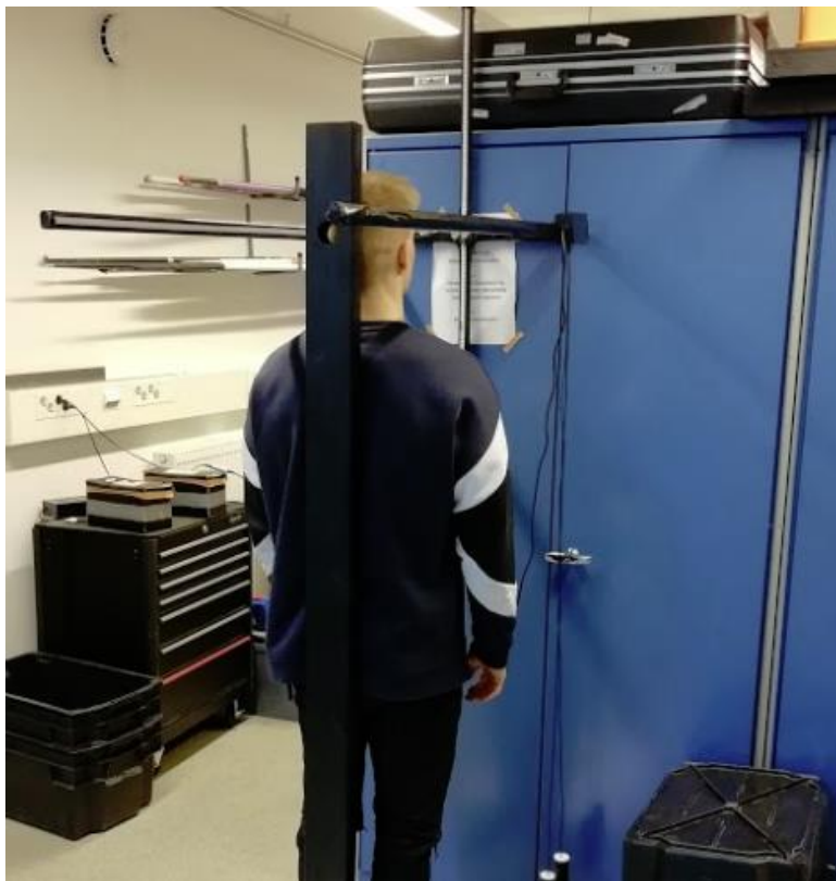
Kuvio 17 Ultraäänianturin tarkkuuden määrittämiseksi mitattaessa otsan etäisyyttä pystysuuntaisesta LED-nauhasta.
