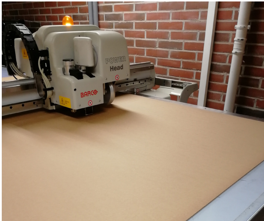
Kuva. 43 Tuotteen osien valmistus tapahtuu pöytäleikkurilla Kanto Topias, 2019
