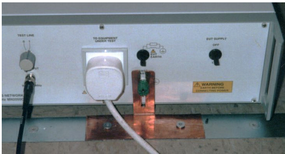
KUVIO 14. Optimaalinen maadoitus keinoverkon ja horisontaalisen maadoituslevyn välille (Elmac Inc. 1997.)
