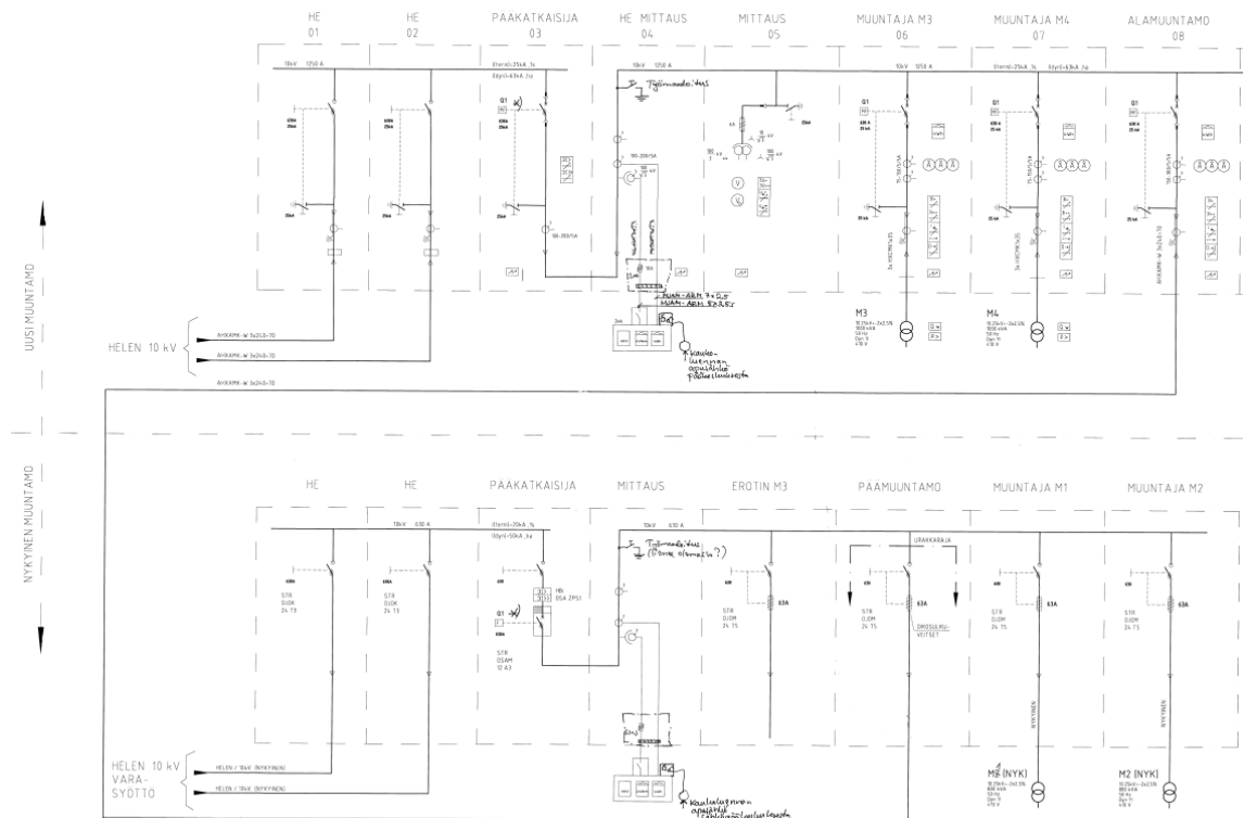
Kuva 16. Ote kohteen 10 kV pääjakelukaaviosta.
