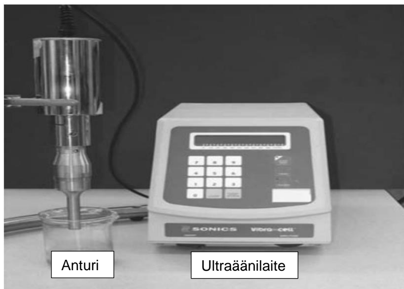
Kuva 4. Kaupallinen suuritehoinen ultraäänilaite, jota käytetään laboratorio-sonokemiassa. [6.]
