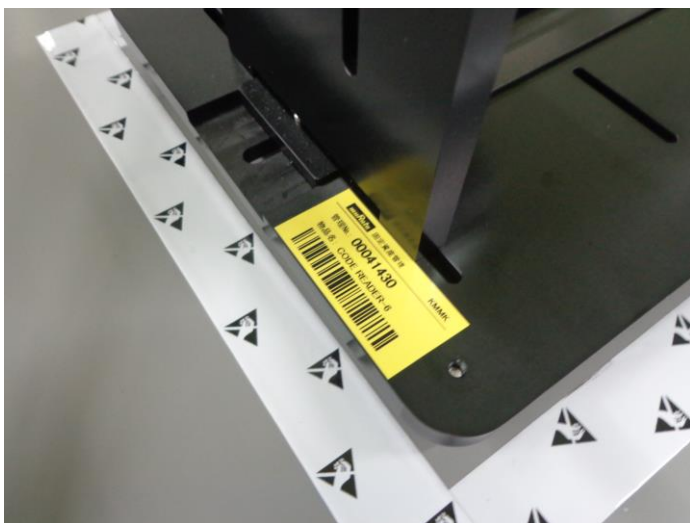
Kuva 12. Viivakoodilla merkattu työkalu jigi.
