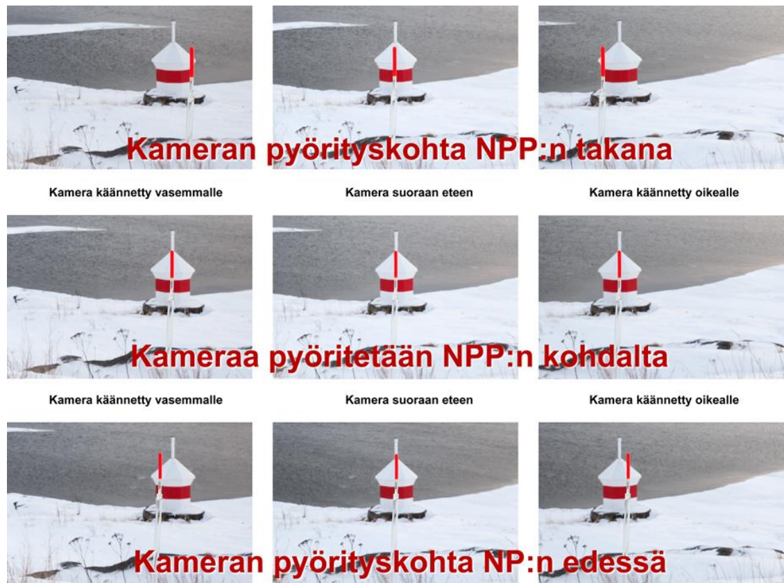
Kuva 8. NPP-piste määritetään liikuttamalla kameran solmupistettä [13].
