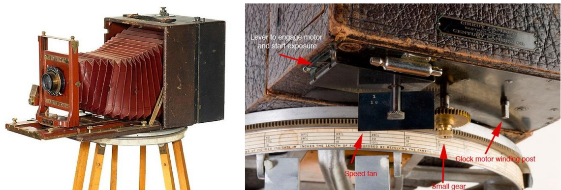
Kuva 3. Cirkut-kamera toimi motorisoidusti pyörivällä kamerajalustalla [10].
