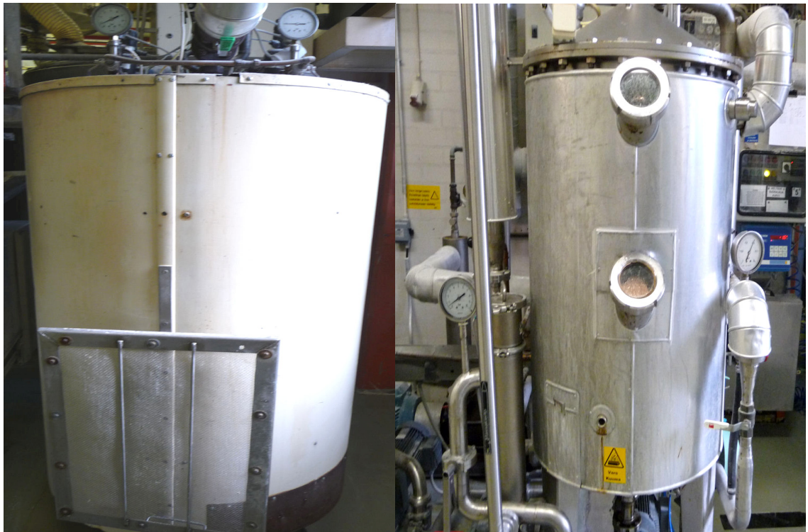
Kuva 1. Jatkuvatoiminen keitin ja vakuumi (Ter Braak).
