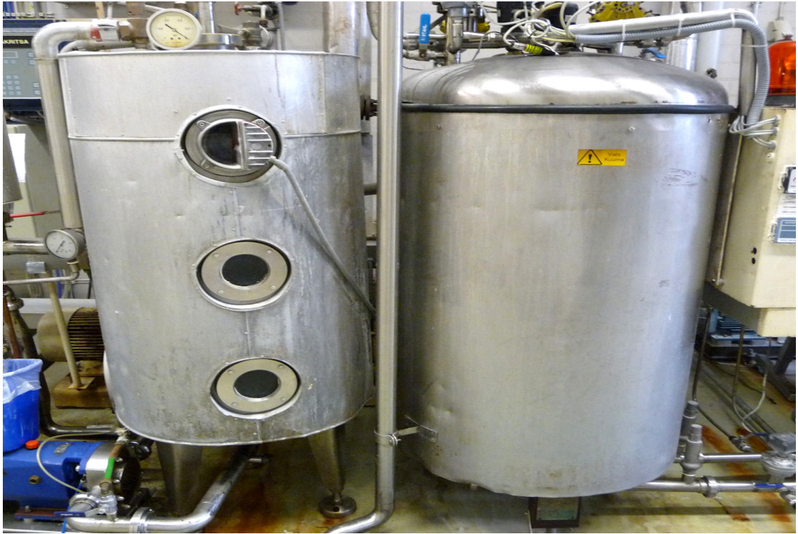
Kuva 2. Jatkuvatoiminen keitin ja vakuumi (Bosch).
