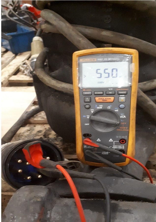
Kuva 25. Eristysvastuksen mittaus (Vannula 2019)
