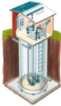
Kuva 12. Mökipumppaamo (Grundfos, n.d.b.)
