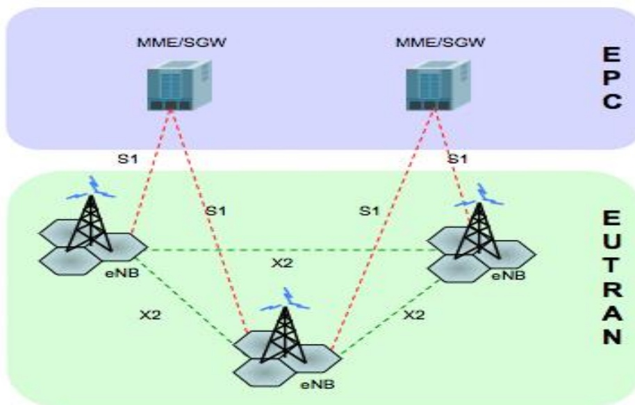
Kuva 3. Evolved Packet System -arkkitehtuuri [6].
