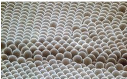
Kuva 17. Suurennettu kuva MICROBEADS ® -kalibrointipartikkeleista. [18.]
