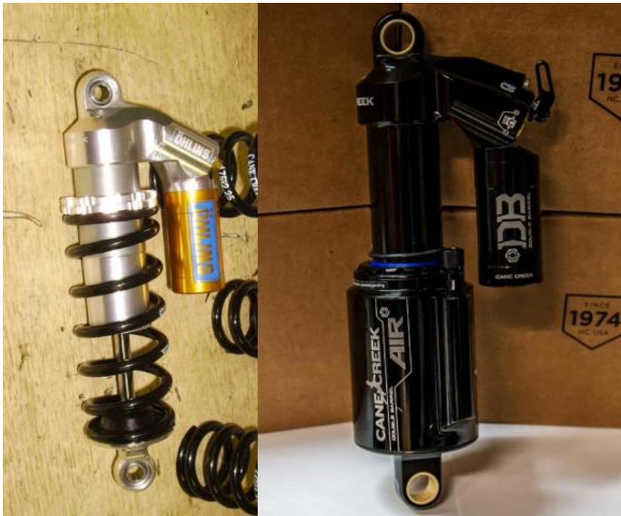
Kuva 6. Formula Studentissa käytetty perinteinen kierrejousi ja kaasujousi.
