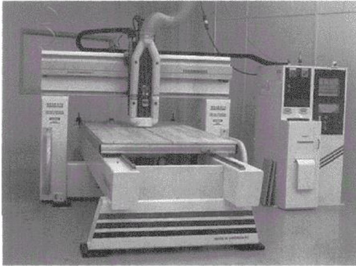
Kuva 6. Portaalimallinen tasojyrsinkone (Brala 2007, 271).
