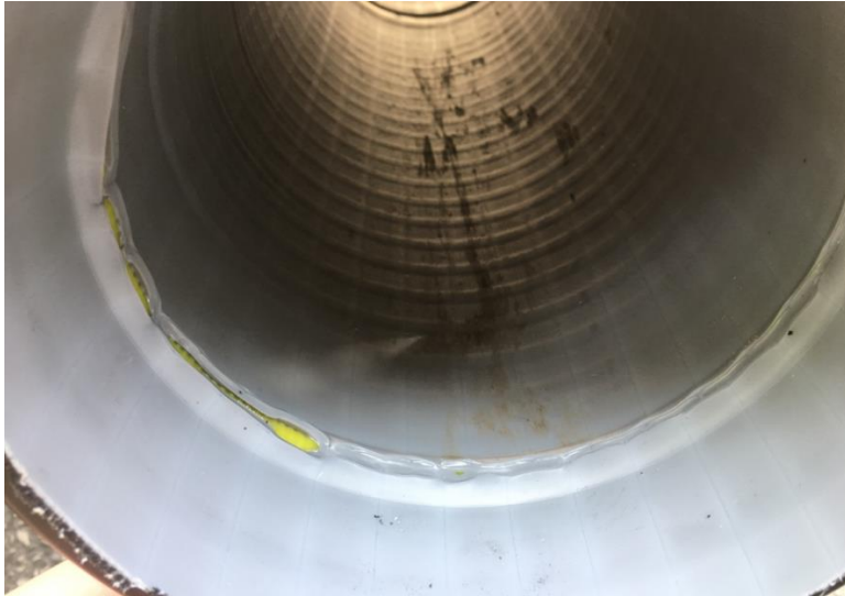
KUVA 13. Hitsaus ilman hitsauspalloa
