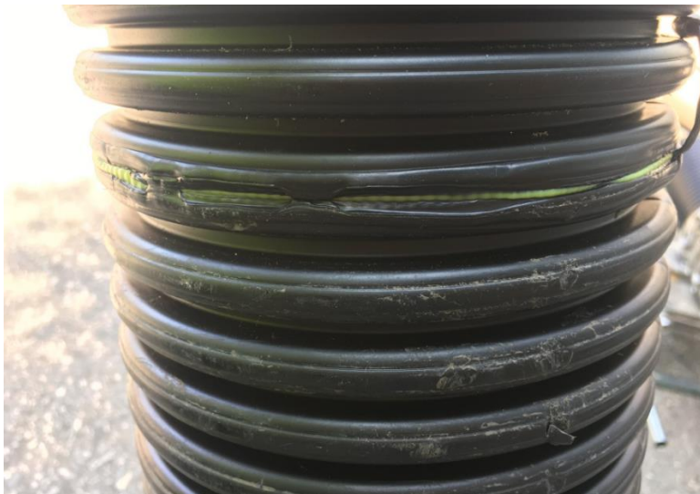
KUVA 14. Epäonnistunut hitsauksen ulkopinta
