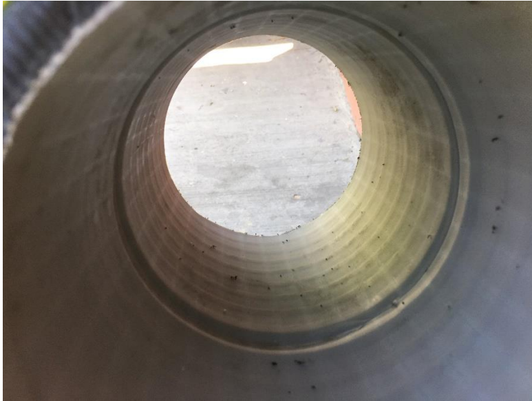
KUVA 11. Onnistunut hitsausauma putken sisällä
