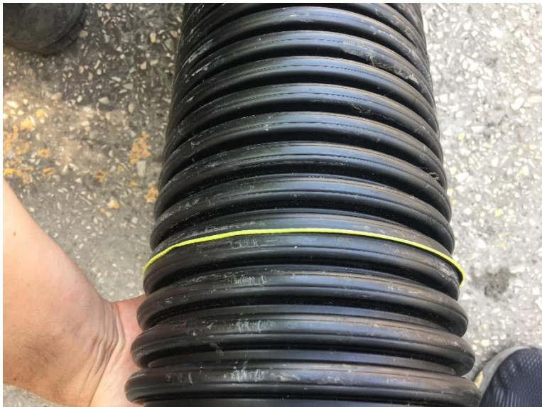
KUVA 12. Onnistunut hitsaus ulkopuolelta
