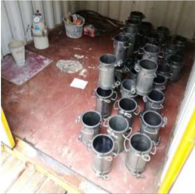
KUVA 3. Työmaakonttiin valmiiksi toimitetut testausvälineet ja muotit
