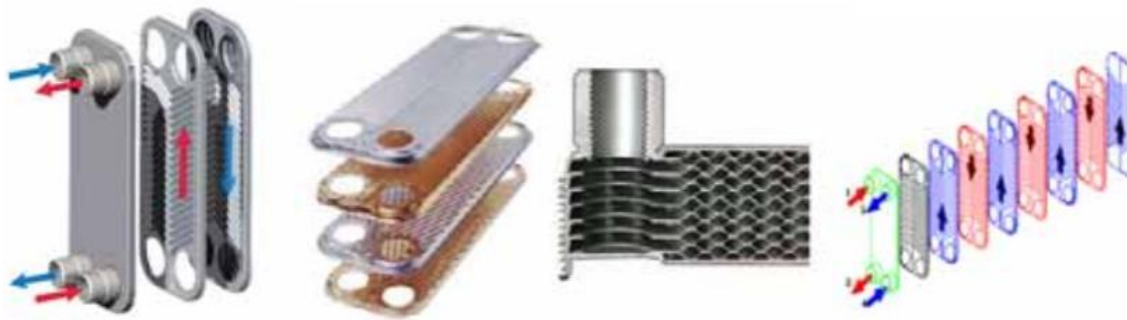
Kuva 1. Juotetun levylämmönsiirtimen periaate (Mäkelä, Tuunanen 2015)
