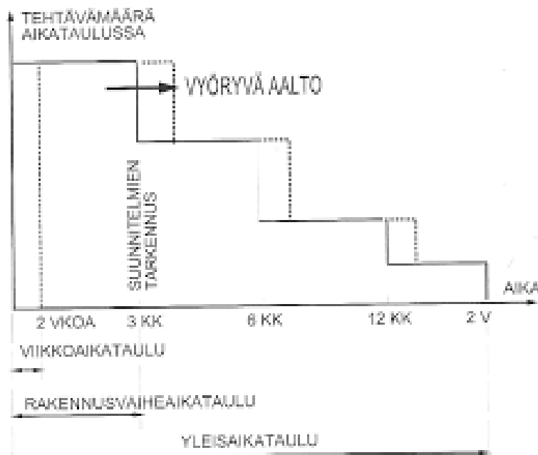
Kuva 4 Vyöryvän aallon periaate [2, s. 122].
