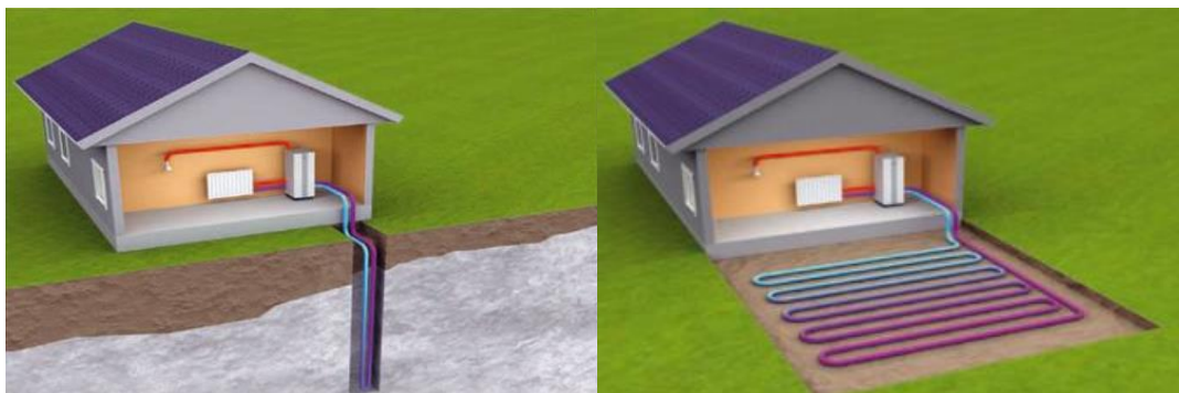
KUVA 10. Maalämpöpumpun yhteydessä tavallisesti käytetyt lämmönkeruupiirit (Danfoss)
