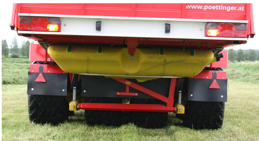
KUVIO 13. Noukinvaunun säilöntäaineannostelu Fellow™ -säilöntäainesäiliöllä
