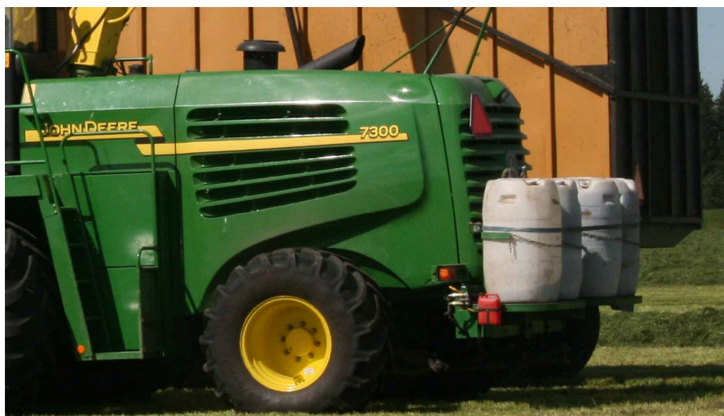
KUVIO 12. Ajosilppurin säilöntäainesäiliöratkaisu: neljä 200 l tankkia
