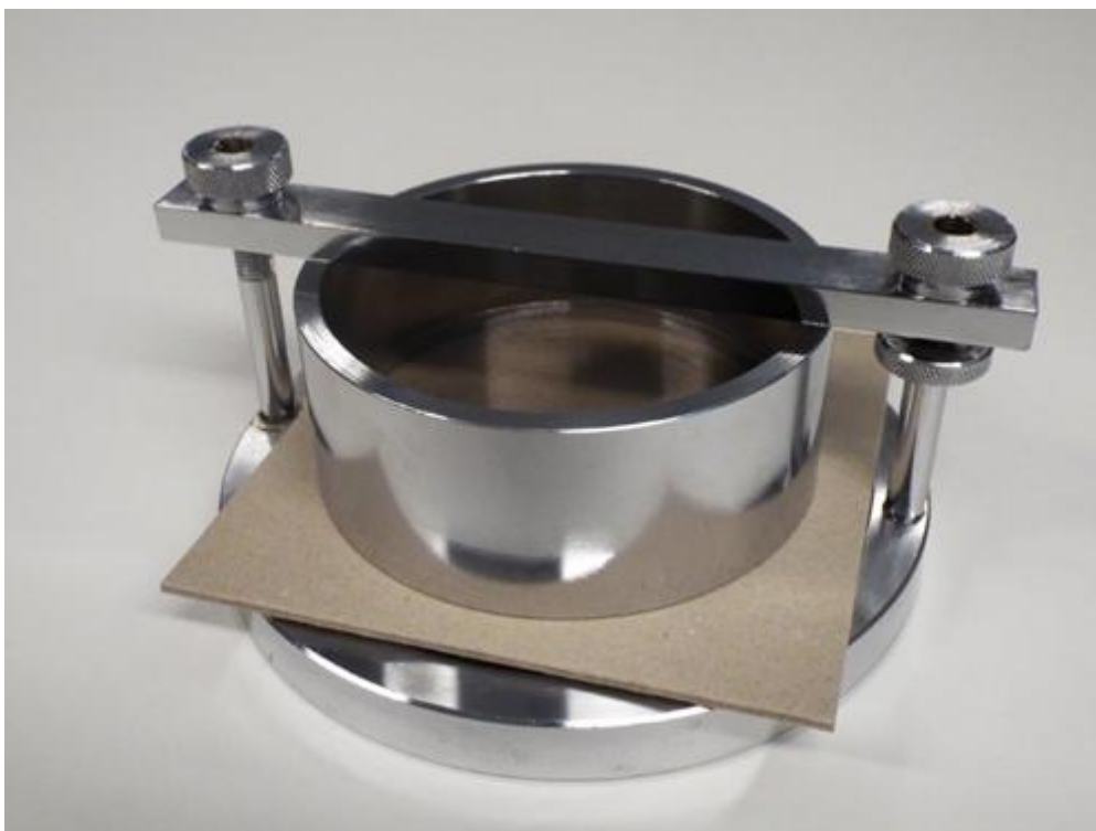
KUVA 5. COBB-testissä käytettävä muotti ja näyte (Kuva: Smithers Group 2018)
