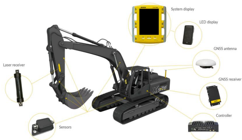
Figur 9. Illustration över maskinstyrningssystemets komponenter.
