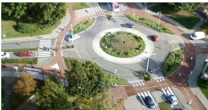
Kuva 5. Hollantilainen kiertoliittymä, jossa on osittain yksi- ja kaksisuuntainen pyörätie. (van Caspel, 2017)
