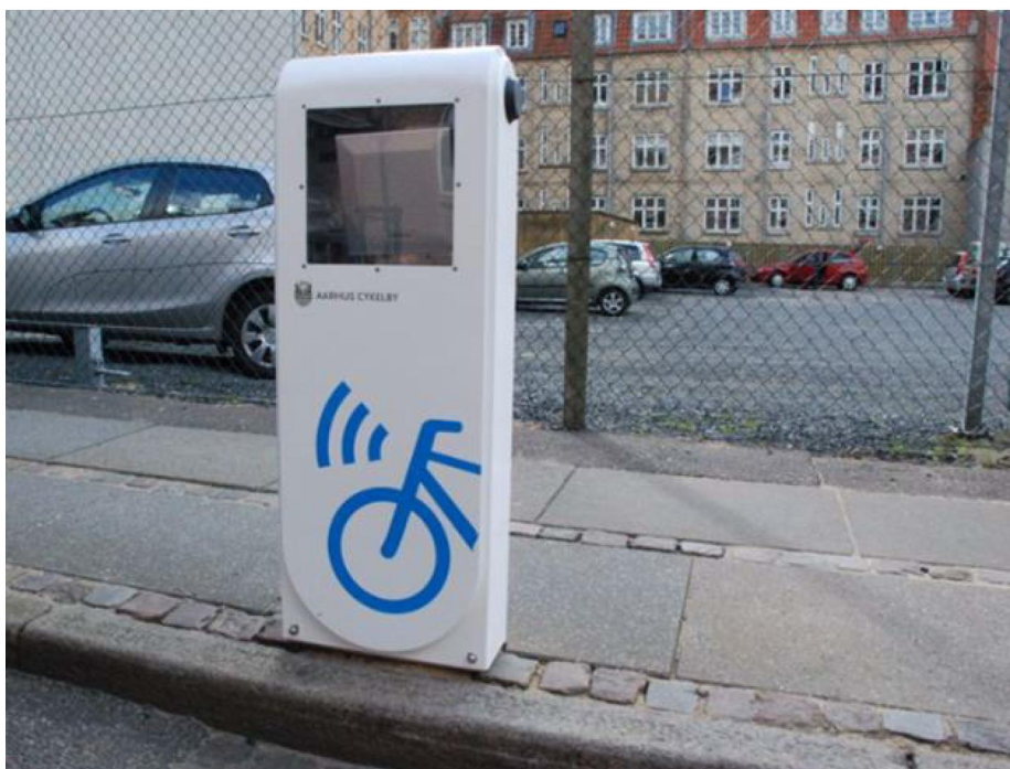
Kuva 39. RFID-tagin skanneri (Garfield, 2015).
