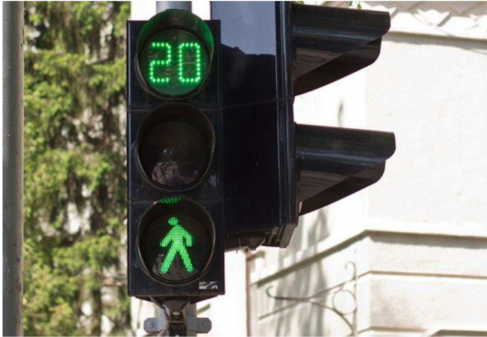
Kuva 34. Jalankulkijaopastimen laskuri sekuntinäytöllä (Ferro, 2014).
