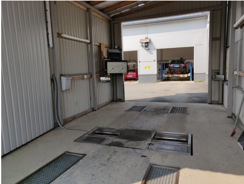
KUVA 4. Jarrudynamometri ja heilahduksenvaimentimien testauslaite
