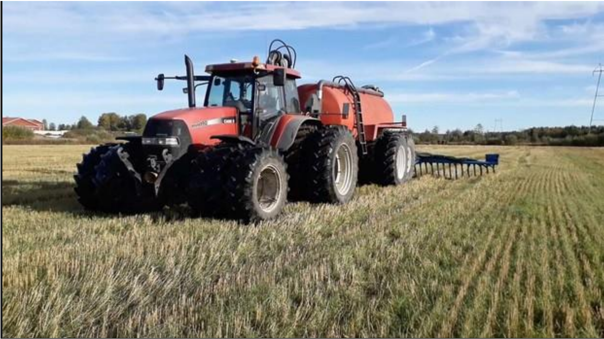
Maaperälle hellävaraisempi vaihtoehto oli Karhumaan Tilan Case MXM 190 ja omavalmisteinen 14 m 3 levitysvaunu 8,6 m Bomec-veitsimultaimella.
