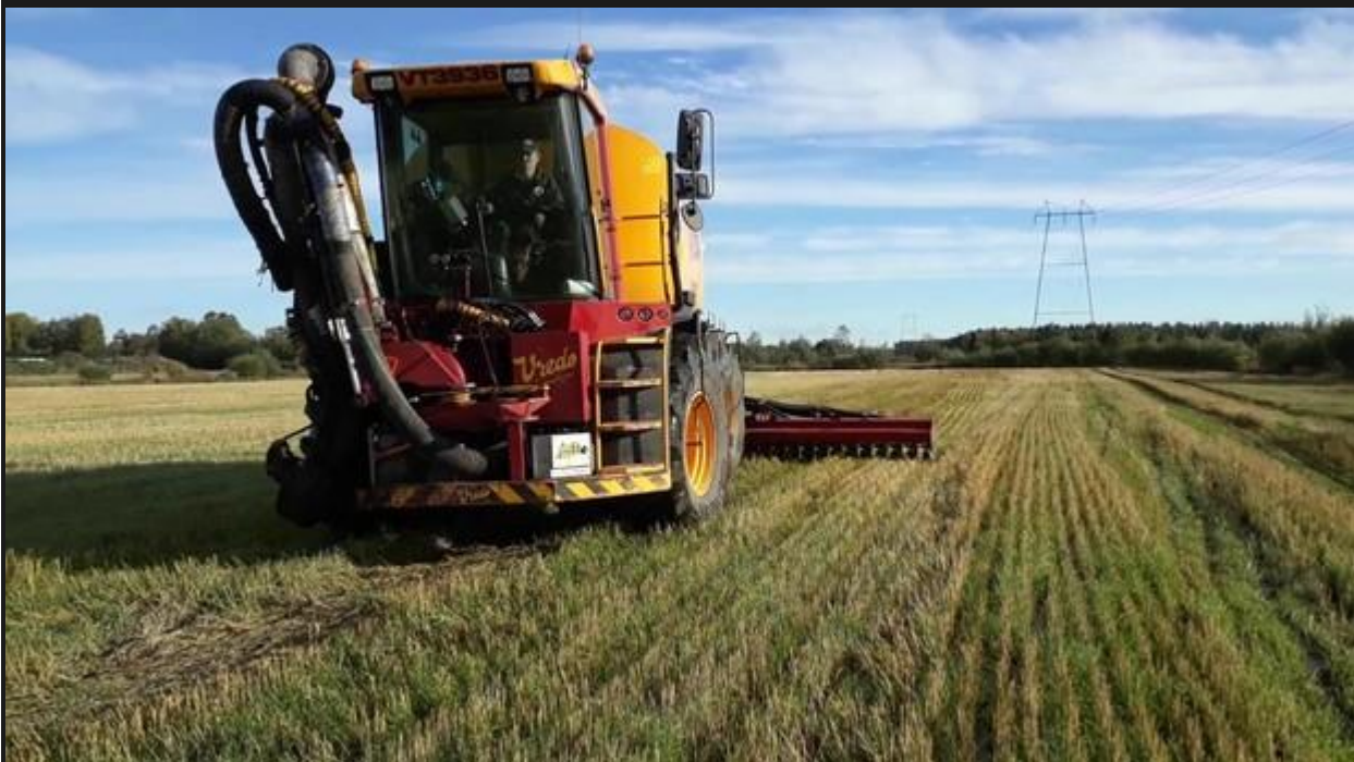
Itsekulkevia lietevaunuja edusti Koskenkoneen Vredo VT3936 17 m 3 :n säiliöllä ja Vredon 2-kiekkoisella 8 m multaimella.
