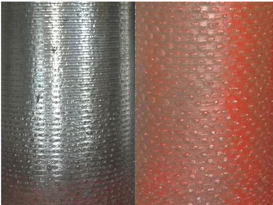
Kuva 8. Vasemmalla kuluneet, kunnostettavaksi lähetetyt telat. Oikealla F-Coran automatisoidusti kunnostettu ja maalattu tela.
