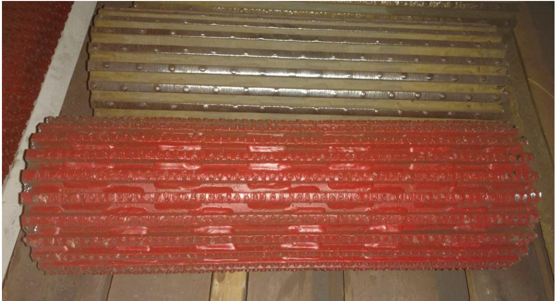
Kuva 5. Edessä F-Coran automatisoidusti kunnostettu ripatela. Takana kunnostettavaksi saapunut tela. Taaemmassa on huomattavissa kulutuksesta aiheutunut ura.
