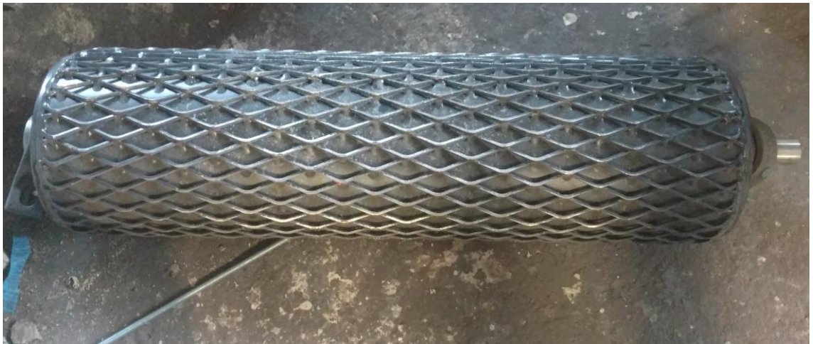
Kuva 4. Käyttämätön Beissbarth-merkkisen jarrudynamometrin verkkotela.
