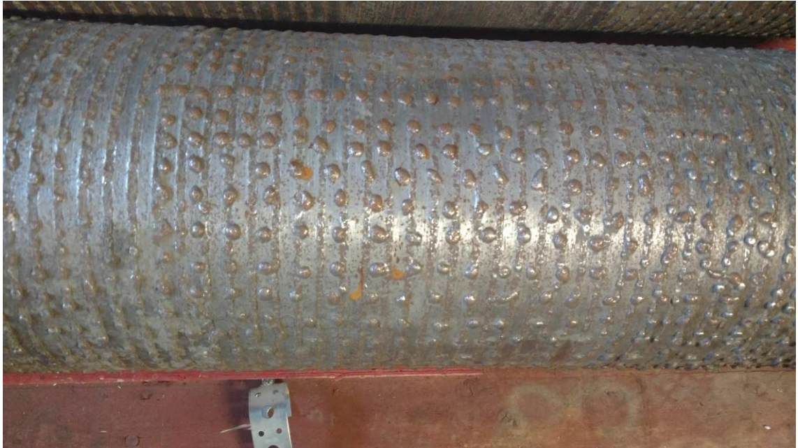
Kuva 6. Kunnostettavaksi lähetetty jarrudynamometrin pyöröhitsattu tela. Telan keskellä on havaittavissa, että sitä on kunnostettu katsastustoimipaikalla käsin pistehitsaamalla, sillä hitsijälki ei ole tasaista eikä sitä ole korjattu koko matkalta.
