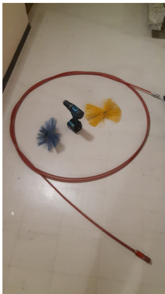
Figur 10. Bild på en borr-vajer med borrmaskin och två borstar. Bild: Rasmus Hellström, 2.4.2019.
