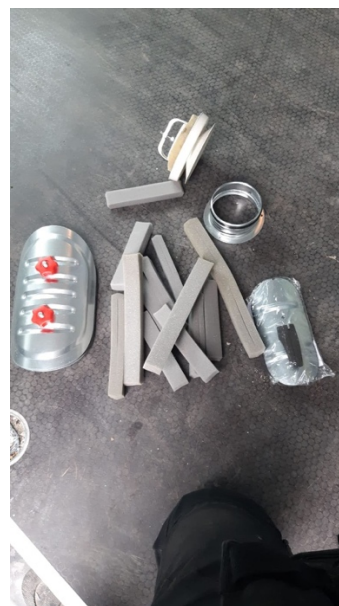
Figur 11. Bild på rensluckor, tätninglistor och ett tilluftsdon. Bild: Rasmus Hellström, 2.4.2019.
