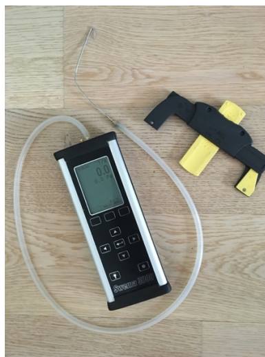
Figur 19. Luftflödesmätare SwemaAir 3000 samt en mätstick för mätande av öppning (springa) i ventiler. Bild: Sebastian Alfthan, 6.5.2019.
