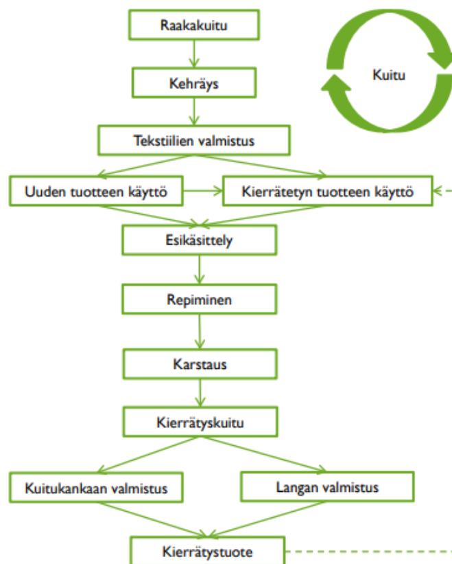
Kuva 7. Mekaaninen kierrätysprosessi ja sen vaiheet. (Dahlbo ym. 2015, s. 35)
