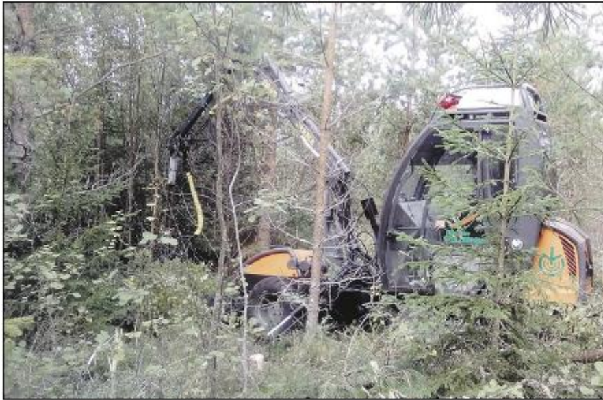
Matias Storm jämförde manuell röjning med maskinell röjning. I den maskinella röjningen användes Usewood Tehojatka. FOTO: Matias Storm
