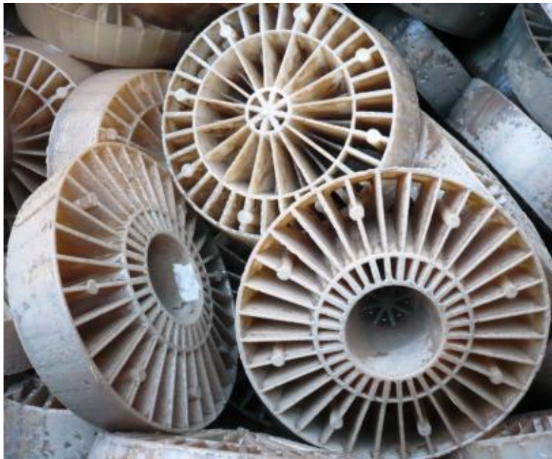
KUVIO 1. GreenRock-puhdistamon suodatinmateriaalina toimivat muovikennot
