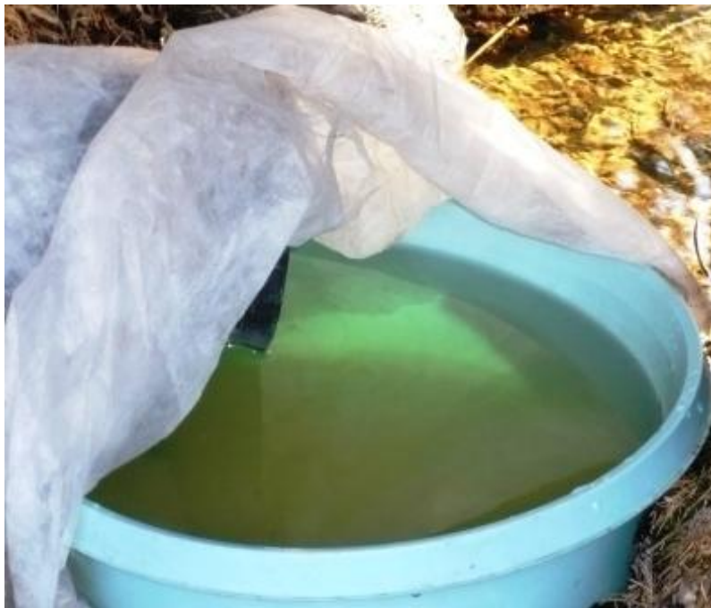
KUVIO 7. Vuorokauden aikana purkautunut jätevesi kerrytettiin purkuputken alle asetettuun astiaan
