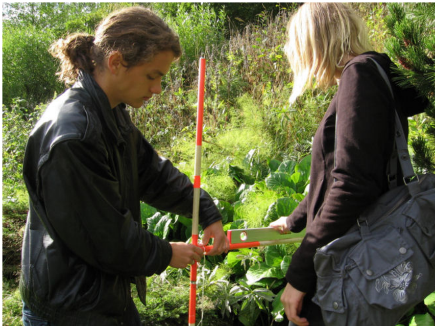
Kuva 2. Portaittaisen mittauksen eteneminen ja välineet.
