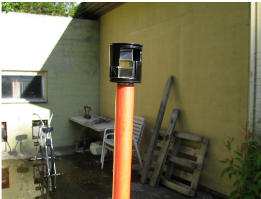
Kuva 3. Suorakulmaprisma linjaseipään päässä.
