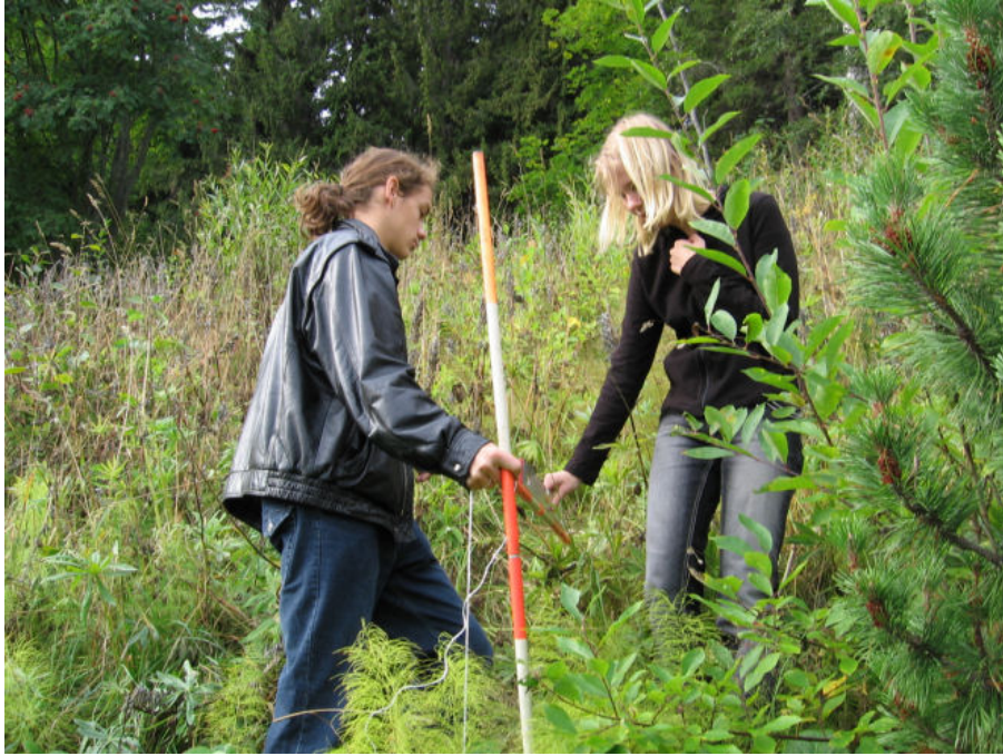
Kuva 1. Portaittainen mittaus alkaa ylämäestä.
