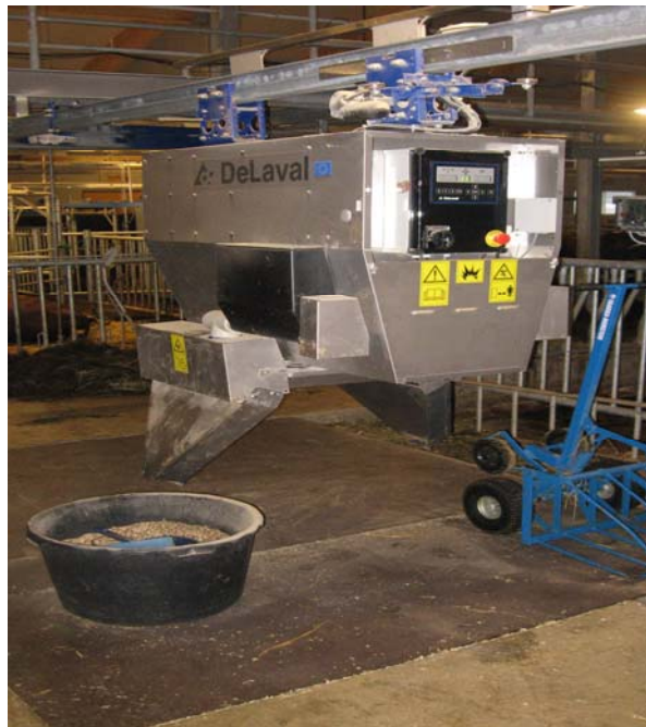
KUVA1. Maidontuotannossa käytettävä kiskoruokkija
