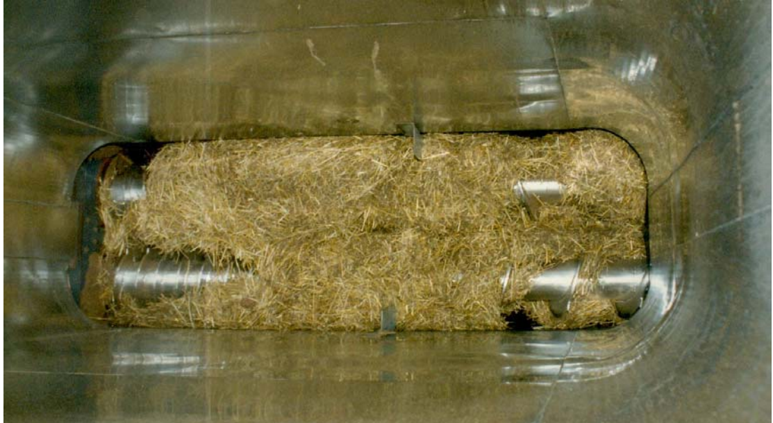
KUVA 9. Syöttöruuvien alkupään (vasen) kierteet ovat loppupäätä tiheimät. Alkupään kierteet tarttuvat kantomurskeeseen, mutta loppupään eivät, jolloin murske alkaa holvaamaan. Kuvassa testataan olkea – ei kantomursketta. (Kuva: Saarijärven Kaukolämpö Oy)
