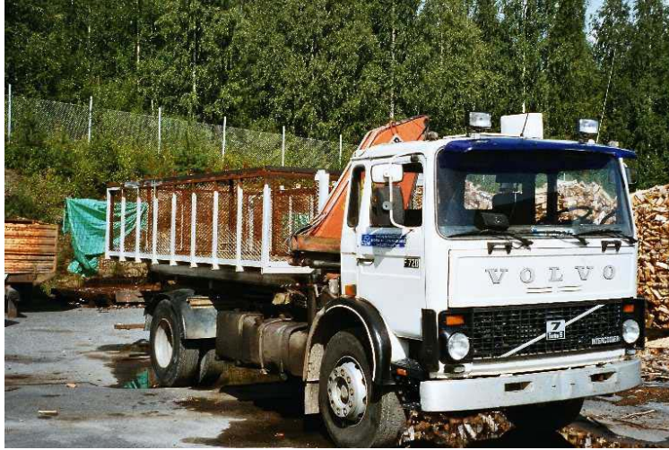
KUVA 31. Vaihtolavavalmiudella ja nosturilla varustettu kuorma-auto sopii suurten pilkemäärien kuljetukseen.
