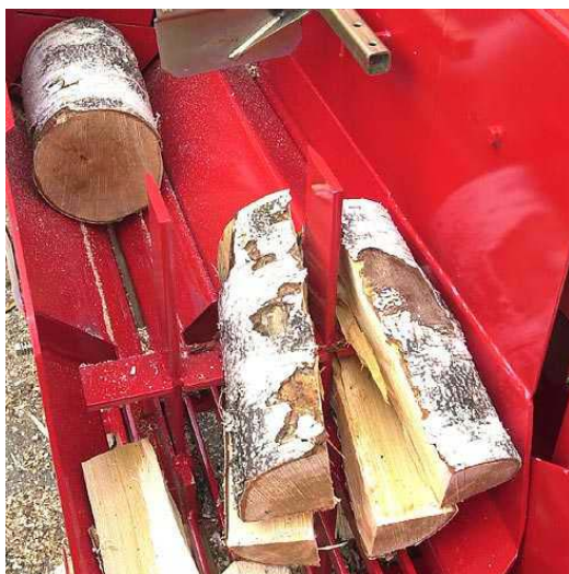
KUVA 9. Hakki 2X:ssä on kaksi halkaisusylinteriä, jotka toimivat vuoronperään (Maaselän Kone Oy 2003).
