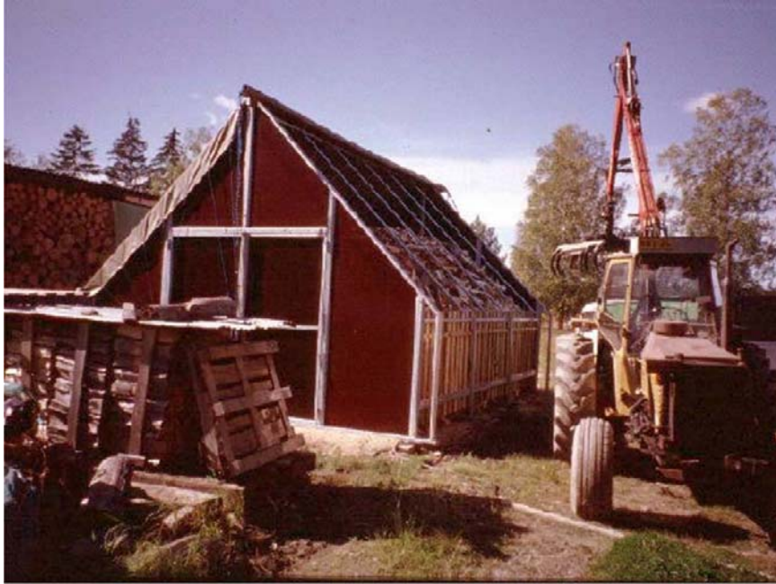
KUVA 23. Siirrettävän kuivurin tyhjennys tehdään rehupiikein varustetulla puutavarakuormaimella (OPET Finland 2001, 23).
