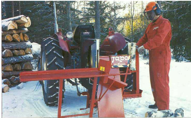
KUVA 4. Kuvassa Japa sirkkelipilkkoja, jossa halkaisu tapahtuu ruuvilla (Laitila Rautarakenne Oy 2003).
