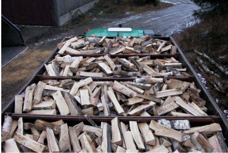
KUVA 32. Eräs ratkaisu on jakaa vaihtolava lokeroihin, jolloin yhden ajokierroksen varrelle voidaan valita useita asiakkaita (Harju 2003).
