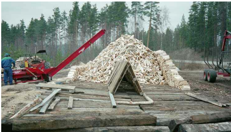
KUVA 18. Pilkkeitä valmistettaessa aumamaiseen muodostelmaan ilmankiertoa voi- daan tehostaa tekemällä kuormalavoista tunneli kasan keskelle.
