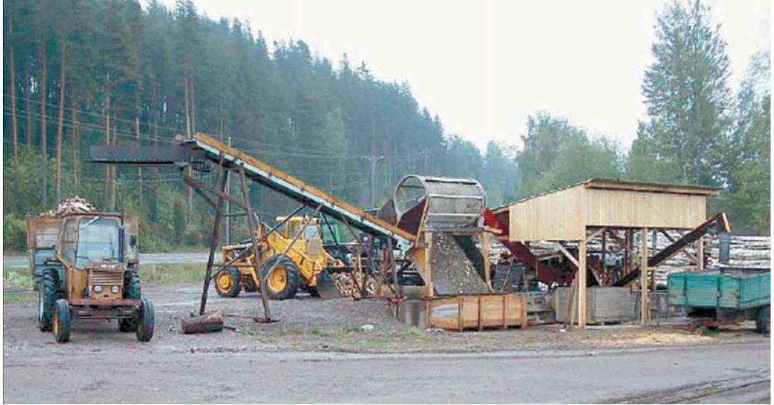
KUVA 17. Kun pilkkeitä valmistetaan terminaalissa, pilkkeiden tuotantolinjaa on mahdollisuus kehittää esim. käyttämällä seulaa (Jalonen 2000, 10).
