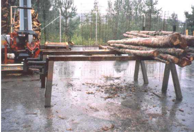
KUVA 16. Puun syöttötason käyttäminen parantaa pilkekoneen tuottavuutta.
