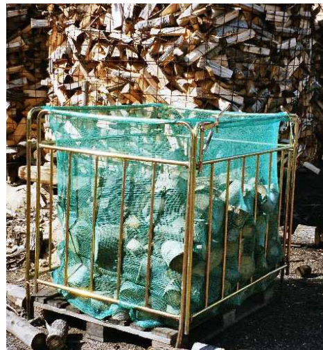
KUVA 22. Kuormalavan päällä olevia pilkehäkkeitä ja verkkosäkkejä voidaan käyttää sekä kuivaus- että jakeluyksikkönä.
