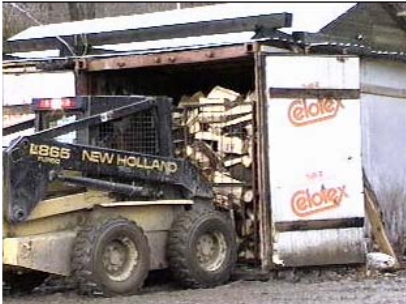
KUVA 29. Lämminilma konttikuivuri (Rinne 2001, 59).
