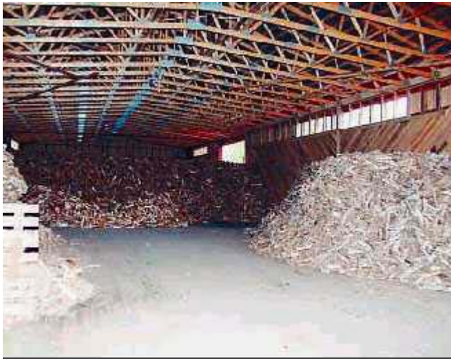
KUVA 26. Suurta varastohallikuivuria voidaan käyttää myös pilkkeiden varastona (Jalonen 2000, 11).
