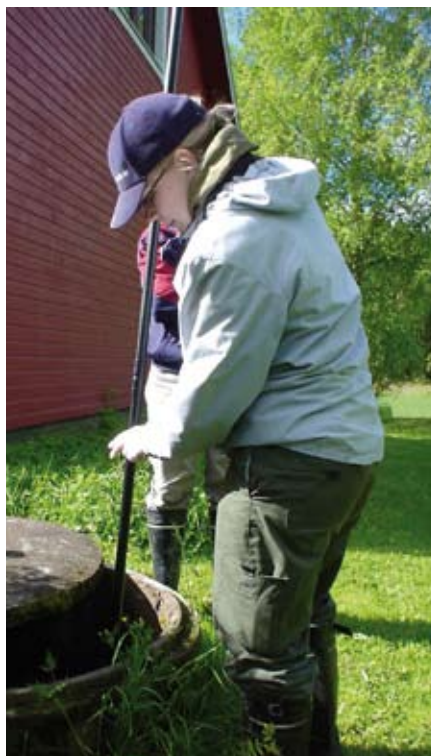
Kiinteistön jätevesiselvitystä varten mitattiin sakokaivojen tilavuus. Nina Pimiä kepin varressa. Kuva: Katja Oksala.
