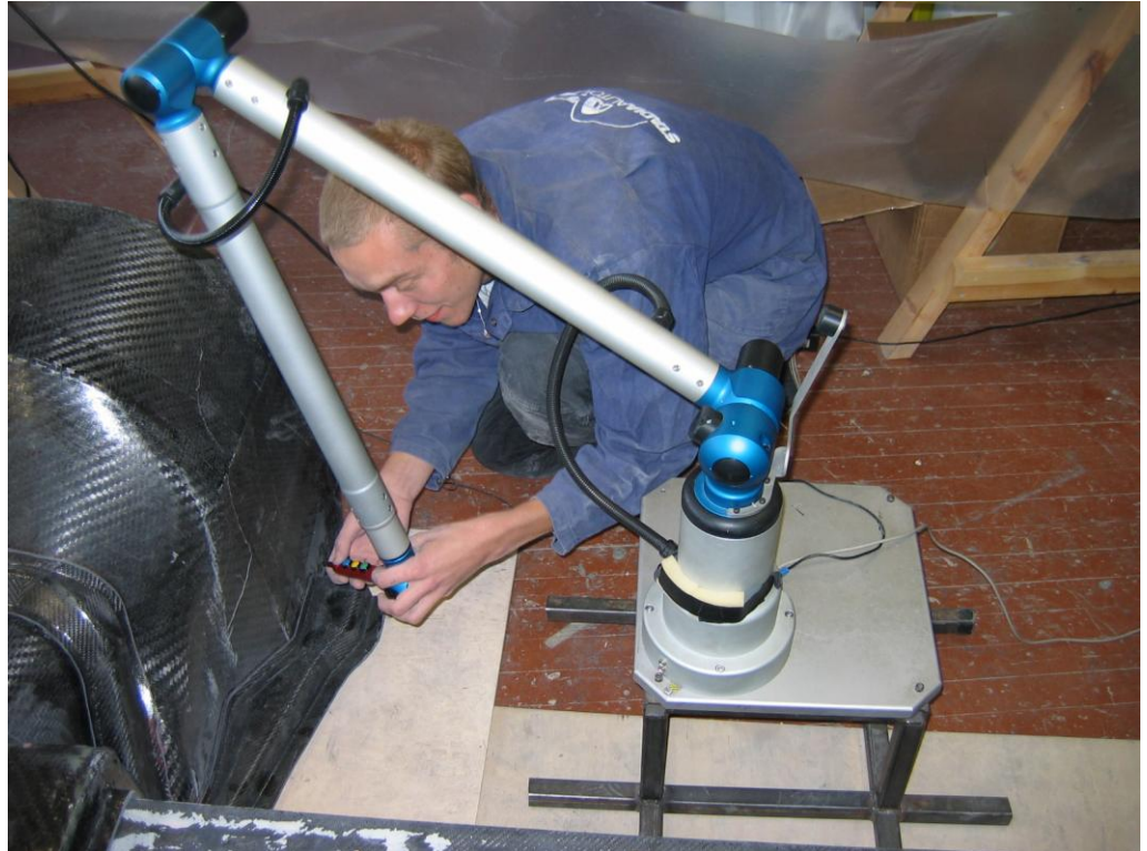
Kuva 12. Osien paikantamista ennen liimausta elektronisen mittakäden ja tietokoneen avulla
