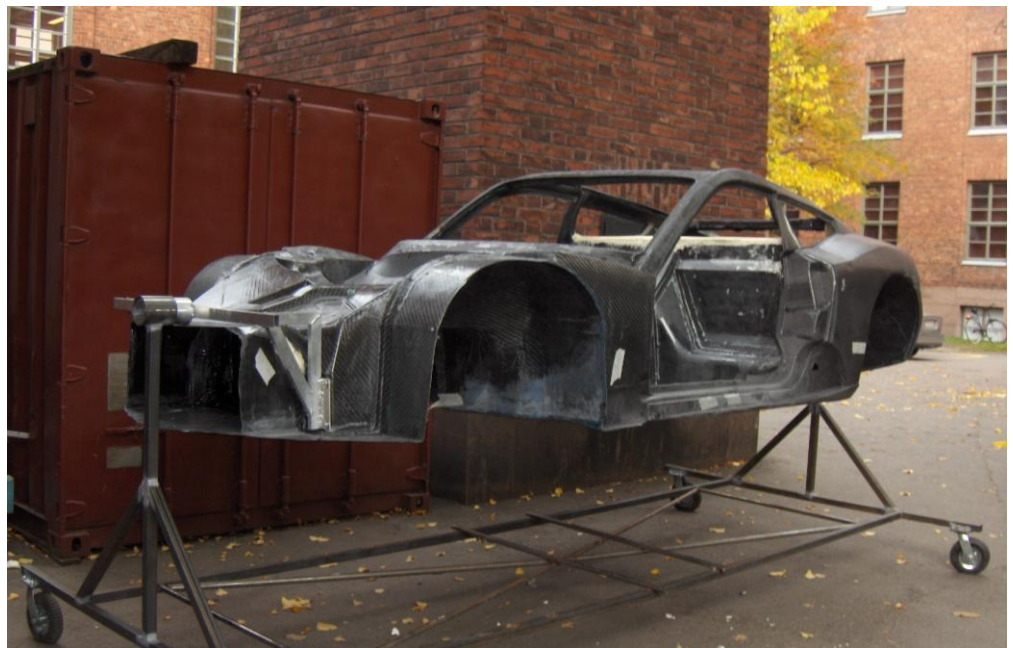
Kuva 4. Raakakori, korin pyörittymisen mahdollistavan koripukin päällä. Korissa ei ole paneeleita kiinni.
