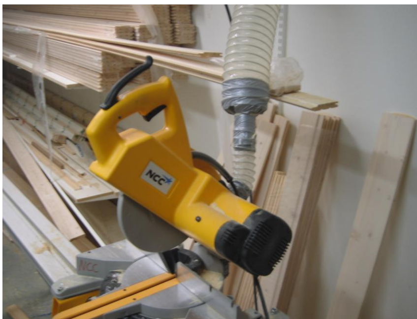
Kuva 5. Kohdepoistolla varustettu käsisirkkeli poistaa pölyn tehokkaasti
