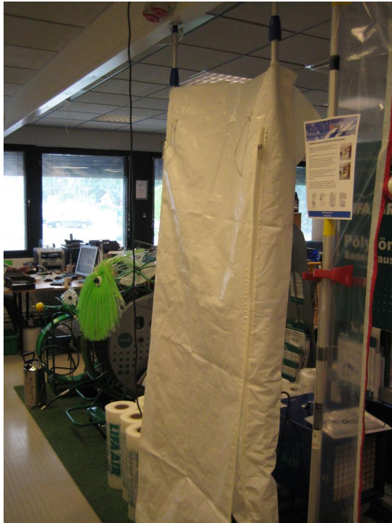
Kuva 18. Raskaammasta muovista valmistettu suojaseinän kulkuaukko
