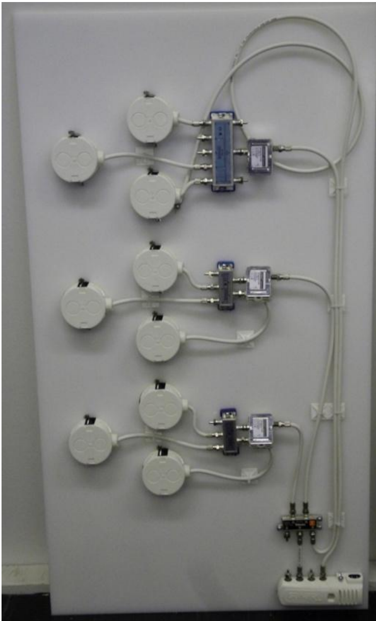
Kuva 22. Kerrostalon antennimalli takaa. Oikeassa yläreunassa näkyvä kaapeli tulee antennilta.
