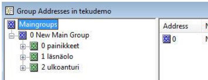
Kuva 49. Painiketaululle, läsnäoloanturille ja hämäräkytkimelle luotiin omat väliryhmänsä (MiddleGroup).
