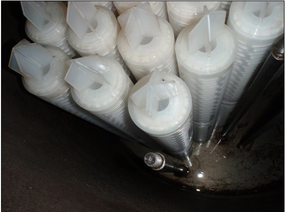
Kuva 16. Kiertokaasukompressorin imusuodatin avattuna paineastiaseisokissa 2010.
