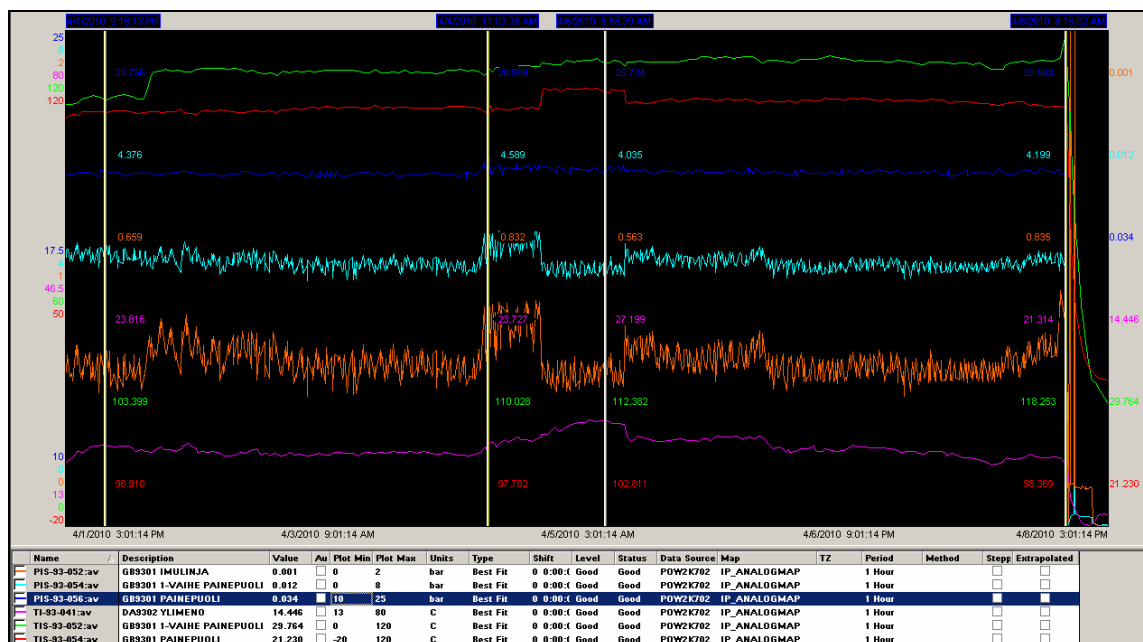
Kuva 11. Lämpötila- ja painetrendit ennen rikkoutumista 8.4.2010. [13.]
