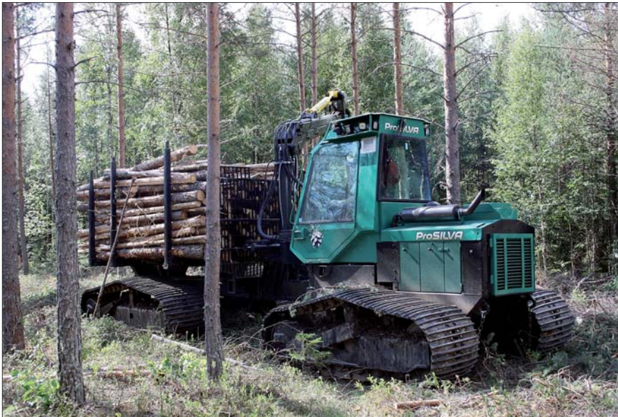
Kuva 4. Jäykkätelainen ProSilva 810 T -kuormatraktori-prototyyppi, jossa on 800 mm leveät Berco-kaivukonetelastot. Takatelaston maata koskettava pituus on 2,4 m ja etutelaston pituus 2,0 m (8 cm:n painumaoletus). Valokuva: Kalle Kärhä, Metsäteho Oy.
