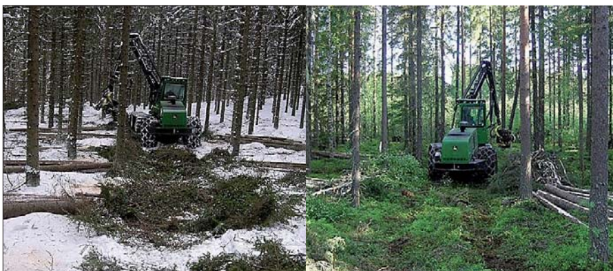
Kuva 1. Perinteinen ainespuumenetelmä (vasemmalla) sekä energiapuukorjuumenetelmä (oikealla).
