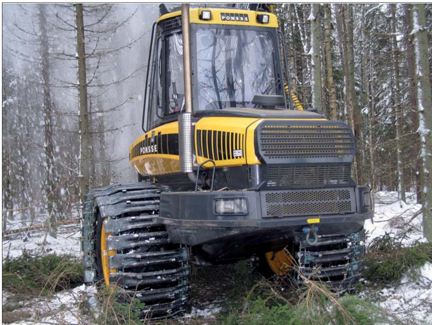
Kuva 3. Nykyistä hakkuukonekalustoa on rakennettu pyörätelojen avulla paremmin sopivaksi heikosti kantavien maiden harvennuksille. Kuvassa epäsymmetriset Eco-Wheel Magnum 700/55-34 -pyörätelat (telakengän leveys 92 cm) Ponsse Ergo -hakkuukoneessa. Valokuva: Kalle Kärhä, Metsäteho Oy.
