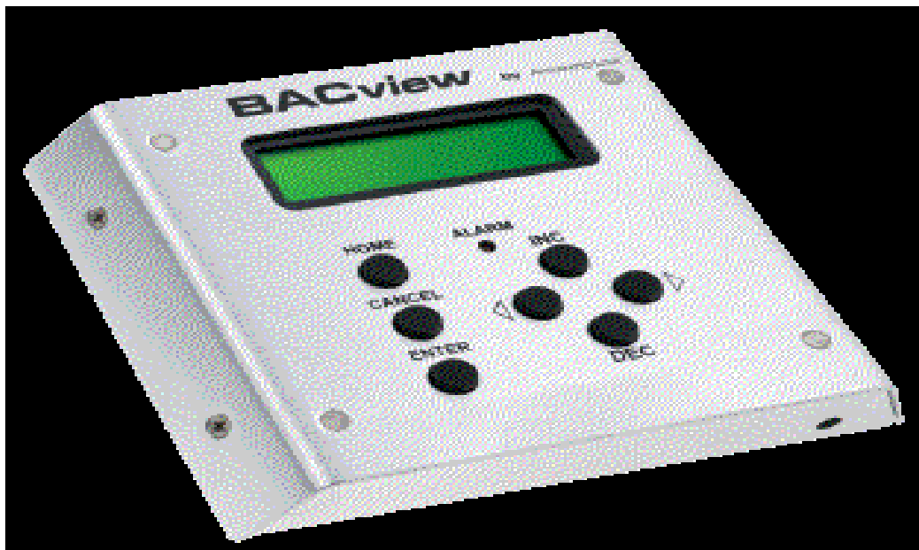
Kuva 6. Paraisten Puhelin Oy:n BACview-operointipäätte (Automated Logic Corporation 2000–2009)
