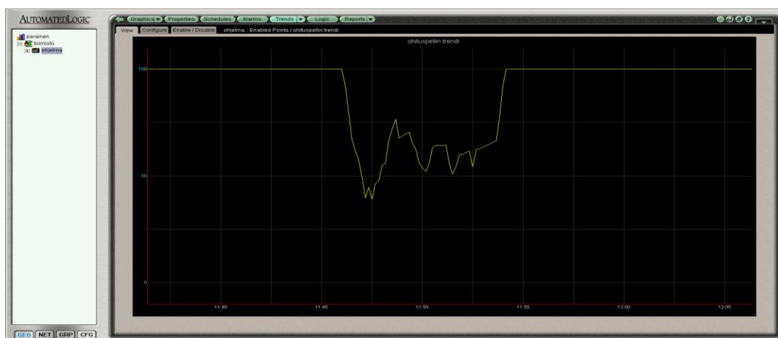
Kuva 23. Ohituspellistön säädön käyttäytyminen talteenottopatterin lauhdelämmön noustua
