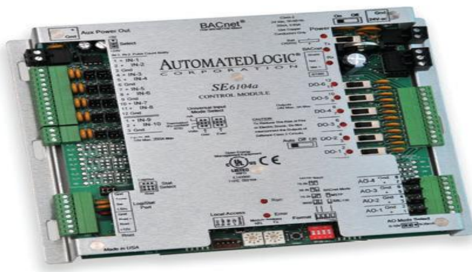
Kuva 8. Automated Logic SE6104a-säädin (Automated Logic Corporation 2000–2009)
